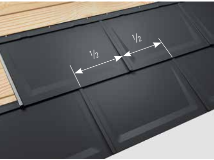
Figure 50 • R.16 - pose et sens de couverture
