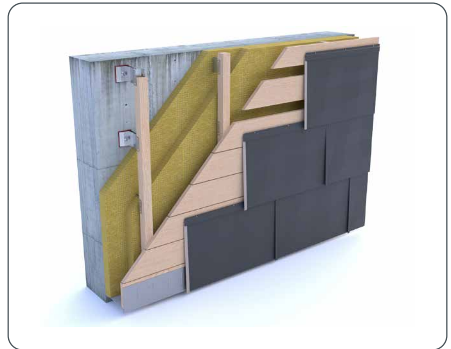
Figure 41 • Panneau de façade FX.12 – Pose sur voligeage non jointif
