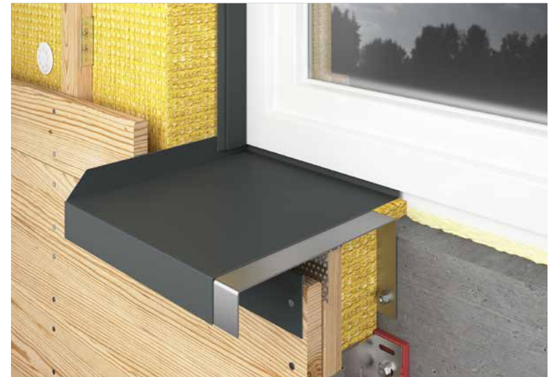
Figure 74 • Montage de la tablette de fenêtre
