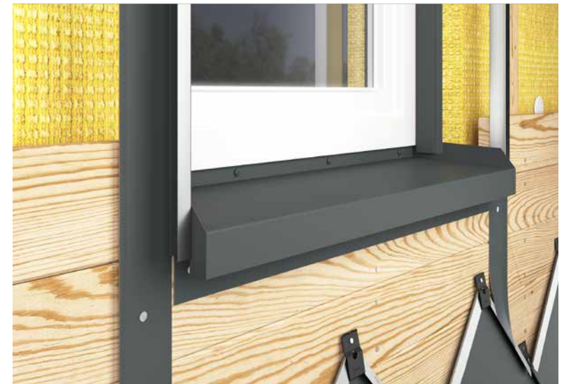
Figure 76 • Montage de l'équerre-support de l'embrasure de fenêtre
