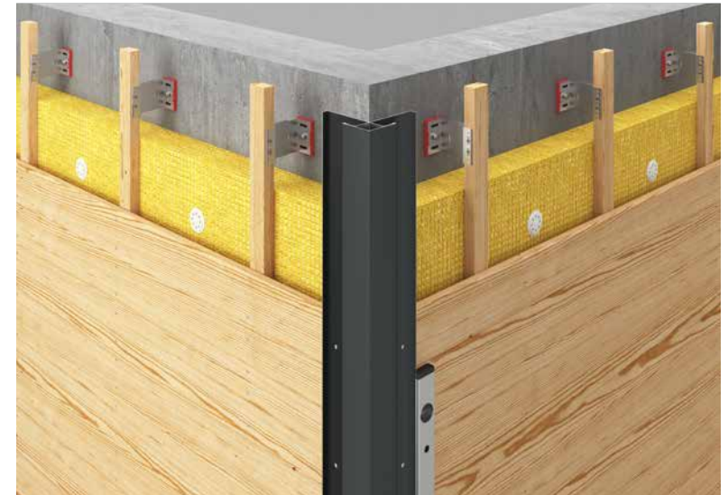
Figure 67 • Angle sortant pose du profilé d'accrochage - petit format PREFA
