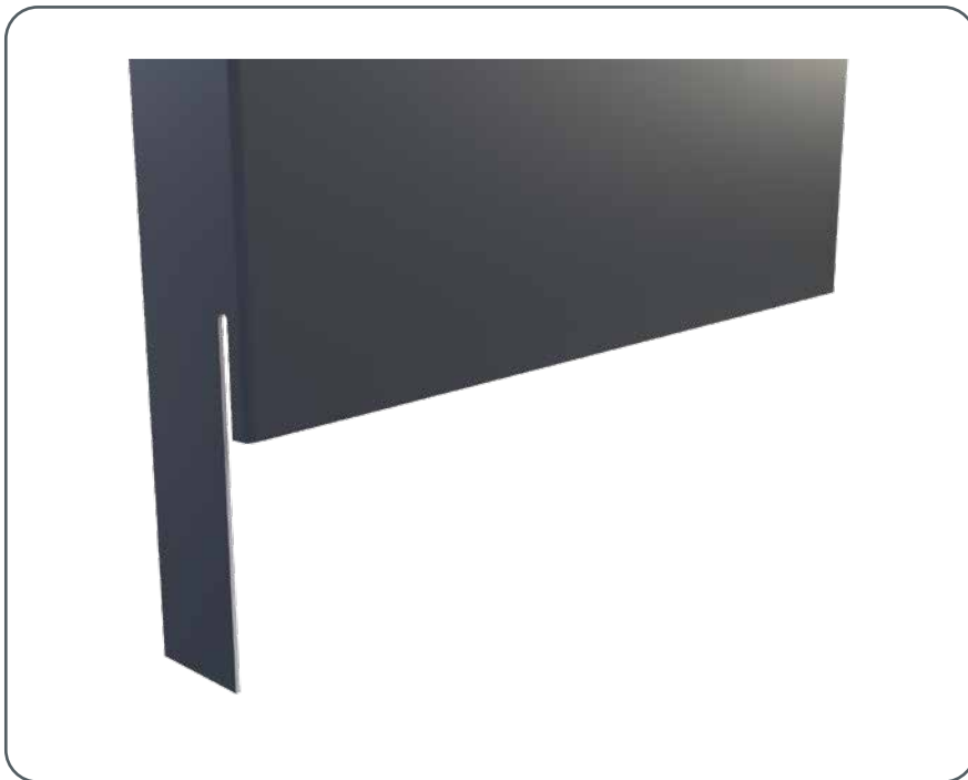
Figure 77 • Partie inférieure de l'embrasure de fenêtre
