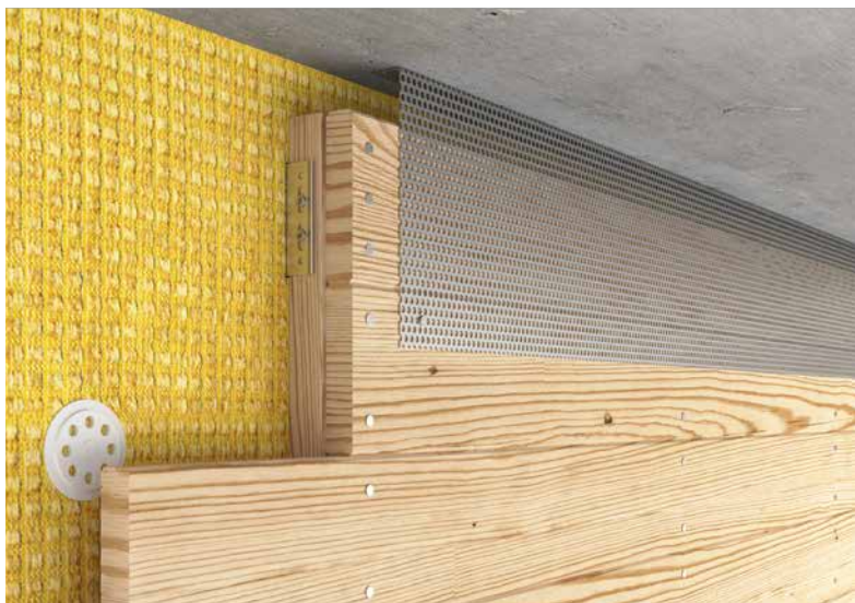
Figure 72 • Raccordement supérieur - préparation
