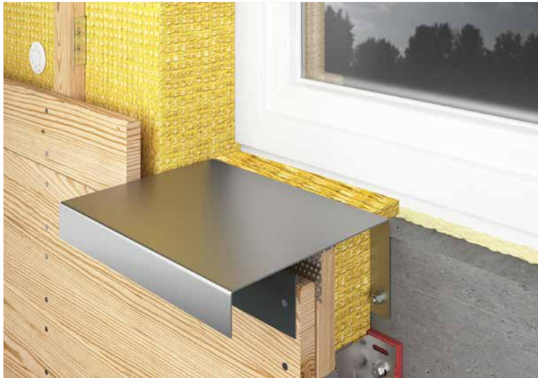
Figure 73 • Montage de la tôle perforée et de la bande de maintien
