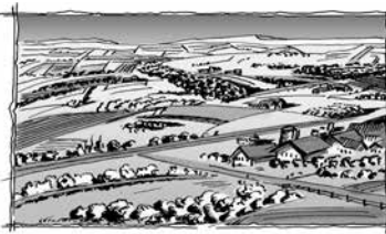
Catégorie de terrain II – Zone à végétation basse telle que de l'herbe, avec quelques obstacles isolés (arbres, bâtiments) séparés les uns des autres d'au moins 20 fois leur hauteur.
