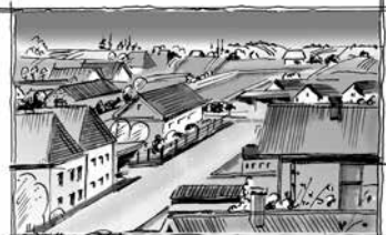
Catégorie de terrain III – Zone avec une couverture végétale régulière ou des bâtiments, ou avec des obstacles isolés séparés d'au plus 20 fois leur hauteur (par ex. des villages, des zones suburbaines, des forêts permanentes).
